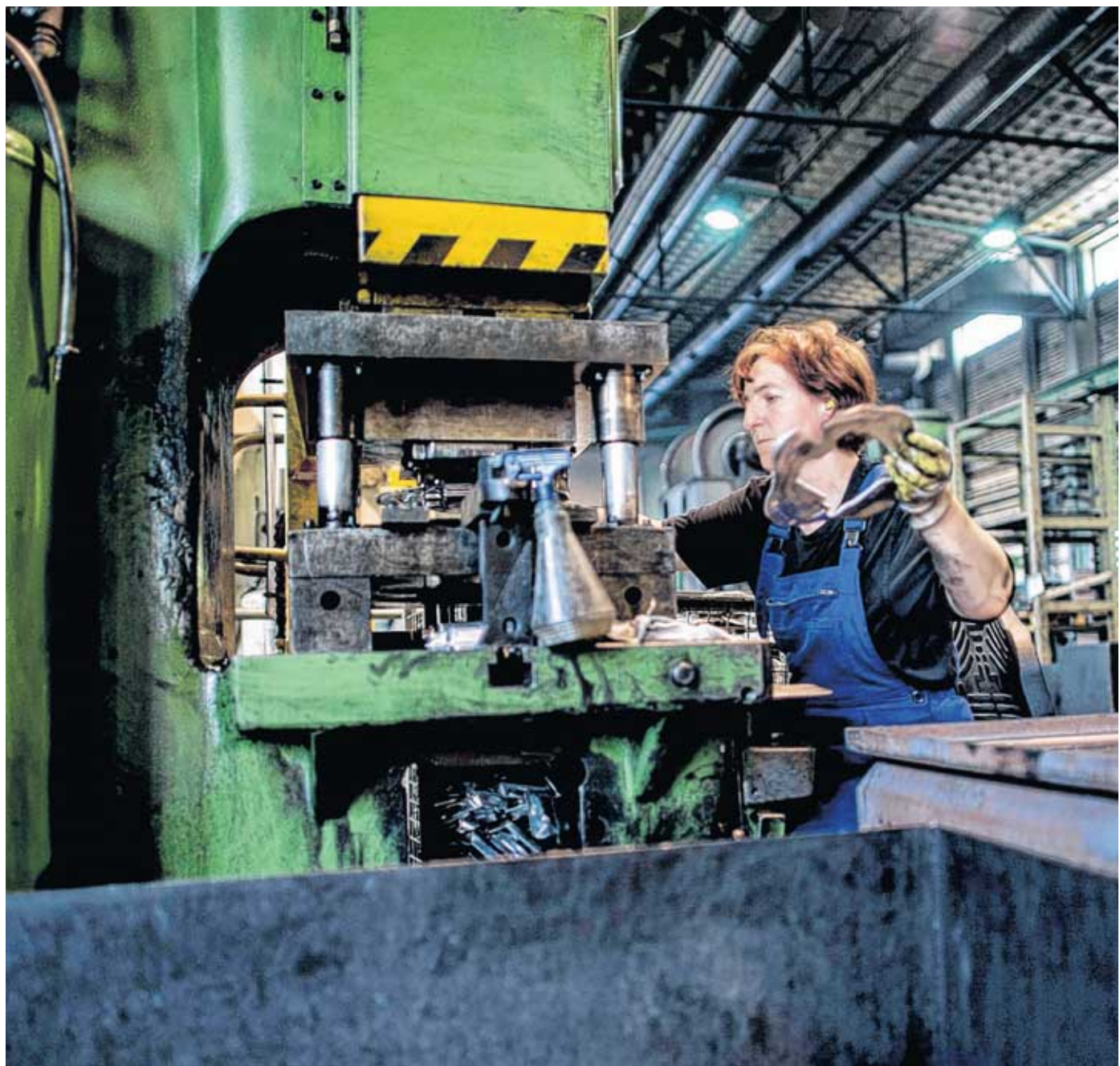
Die Dresdnerin Silke Jorich arbeitet bei der Umformtechnik Radebeul an einer der sechs Abgratpressen, die ab Ende August in dem Neubau unterkommen. Die Maschinen schaffen Platz für eine neue Schmiedepresse. Fotos (3): Martin Förster
