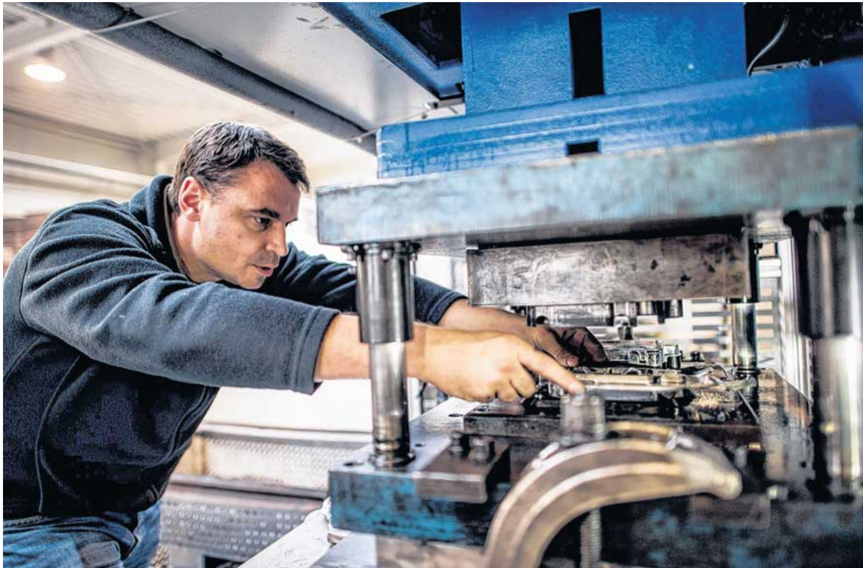
Steffen Kamitz, Leiter der Rohteilfertigung, arbeitet an einer der zwei neuen Abgratpressen. Die Maschine trennt überflüssiges Material vom Aluminiumbauteil ab. Die Metallreste werden per Fließband zum Containerstellplatz transportiert. Fotos (2): Martin Förster
