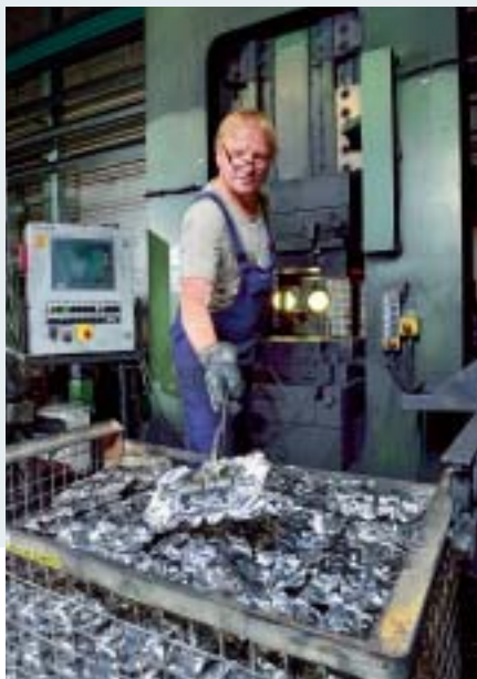
Geschmiedetes Aluminium muss zunächst abkühlen bevor es abgegratet werden kann
